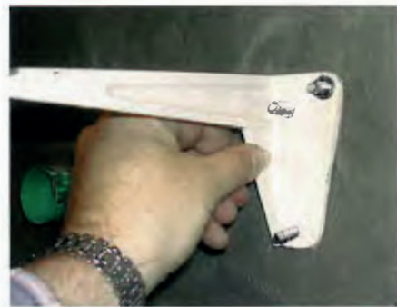
Figur 5.13: Boltene plasseres i hullene med braketten som mal
