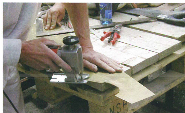
Renskjæring av profil
